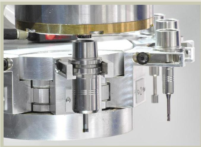
**Bild 3. Werkzeugwechsel und Vermessung eines MKD-Fräswerkzeugs**
