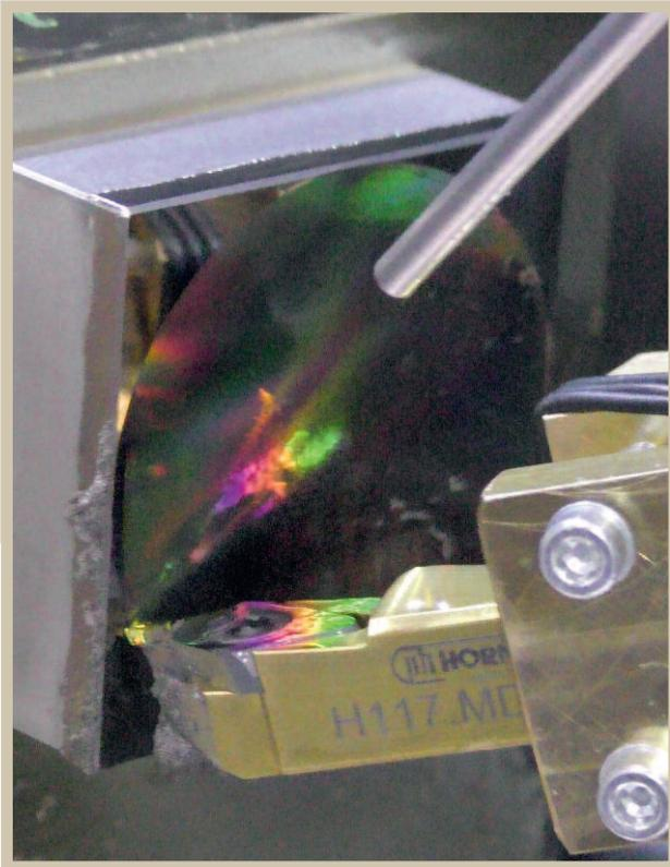
**Bild 5. Fertigung einer Hybridoptik in Nickelphosphor**
