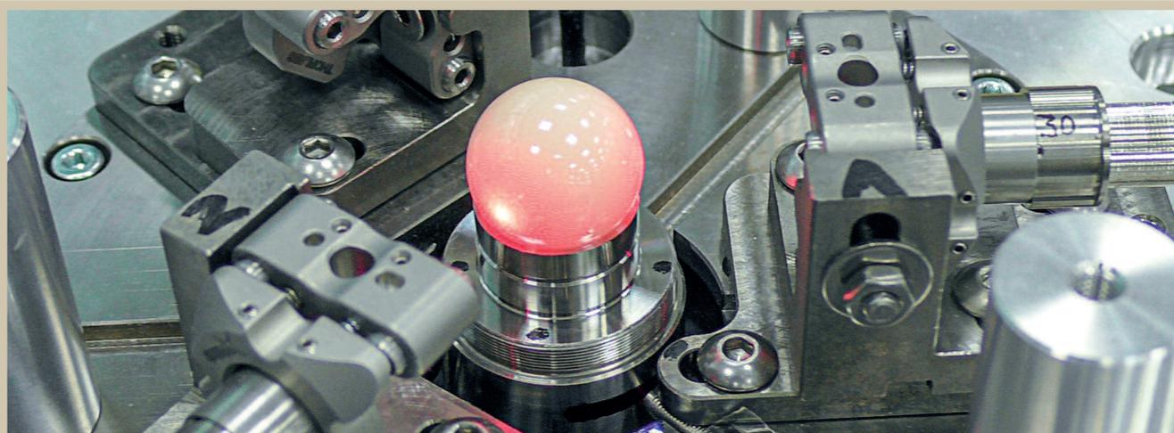
**Bild 6. Interferometrische Rundlaufmessung von LT Ultra-Precision Technology**
