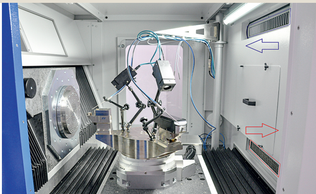
Bild 1. Maschineninnenraum einer »MTC650« mit integrierter Luftzuführung (oben rechts) und Absaugung mit Vorfilterstufe (unten rechts)
