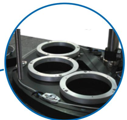
6" Doppelte Messkaskade mit Luftgelagertem Objektivwechsler
