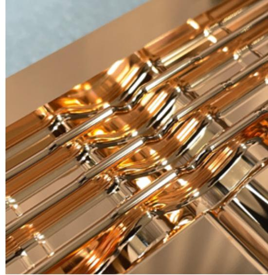
5-Achs UP-gefräste Teilchenbeschleunigerkomponente (CERN)
