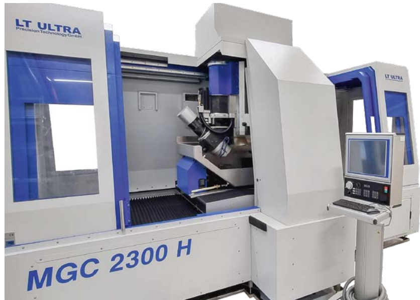
Bild 2. Gesamtanlage ›MGC 2300H‹ mit Kabine und insgesamt zwei Zugangsbereichen für jeweils eine Bearbeitungsstation zum Schleifen und Läppen
